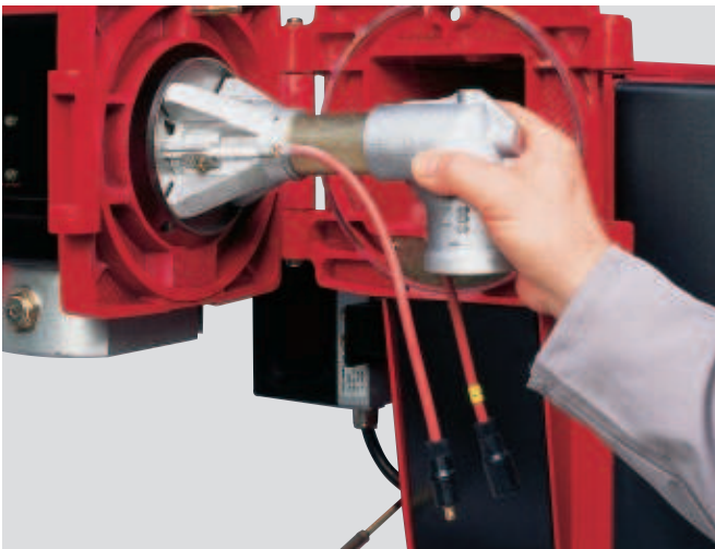
Газовая горелка в исполнении LN: хорошо доступно устройство 4 смешивания
