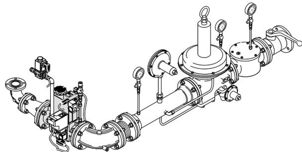
Высокое давление подключения – фланцевая арматура с клапанами DMV и линией газа зажигания\*
