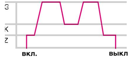
Верхняя кривая: плавно-двухступенчатое регулирование
