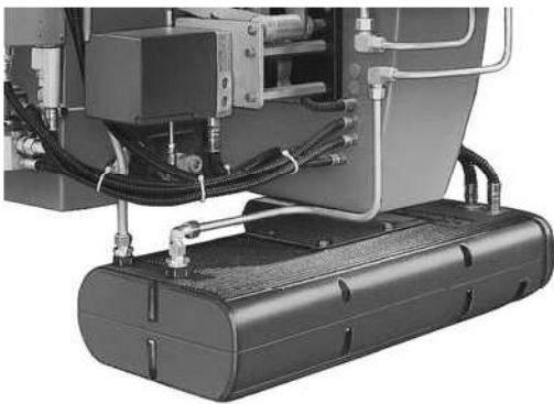
Станция подогревателя теплоносителем
