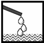
Монтаж следует производить так, чтобы конденсат не стекал обратно в MBC.
