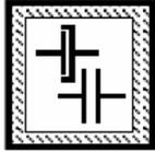
Предохраняйте поверхности фланцев от повреждений. Винты вкручивайте крестообразно. Следите, чтобы при монтаже не произошло перекосов.
