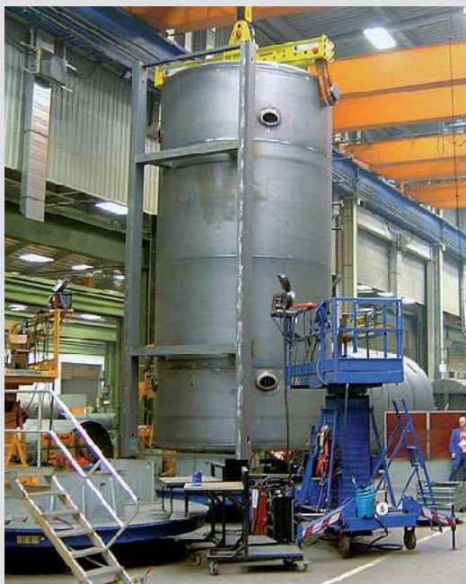
Сварка при оптимальных условиях даже для котла длиной больше 7 метров.
