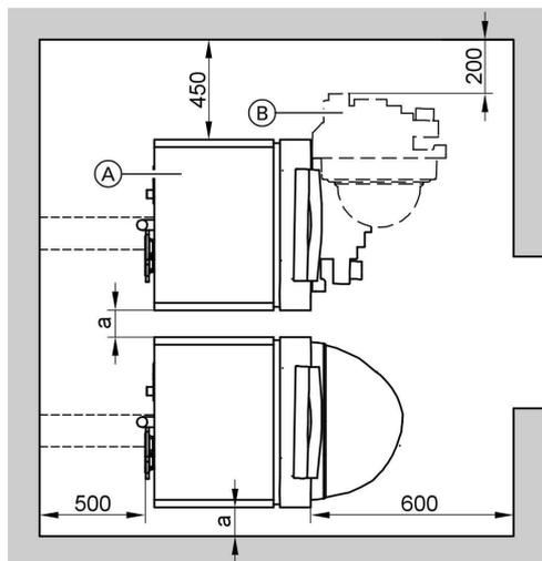
Размер а: 200 - 300 мм (требуется для монтажа газовой арматуры)
